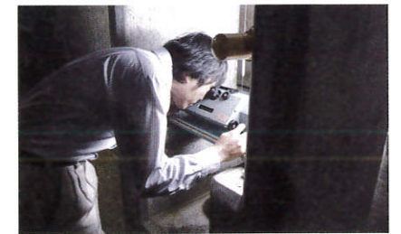
監査廊変位観測
